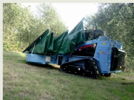
Con il modello MOR-003 si completa la gamma con una macchina integrale fortemente innovativa: un sistema semovente idrostatico multifunzione (o minipala) con attacco anteriore standard per il collegamento di cesto intercettatore con testa vibrante.
